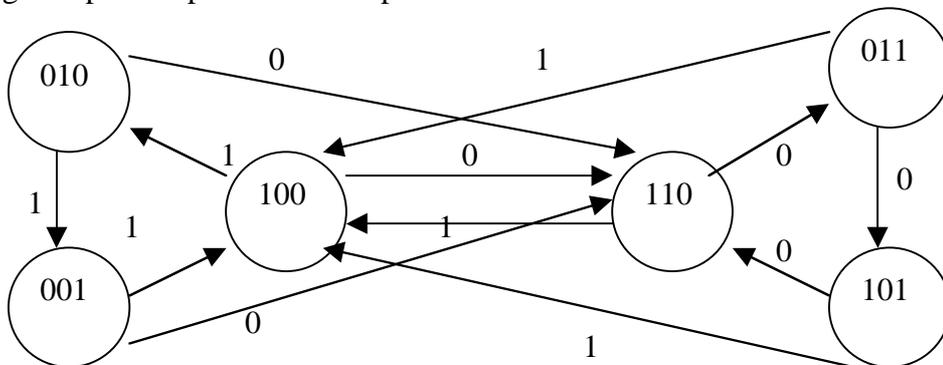
Dato l'automa, si può facilmente ricavare la tabella degli stati futuri e le espressioni booleane per D0, D1 e D2 e per le tre uscite S C e D.
