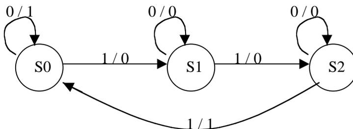
Si noti che l'automata è minimo e che poteva essere modellato bene anche con un automa di Moore (l'unico stato con output 1 è S0). Associamo lo stato S0 con la configurazione  $Q1 Q0 = 00$  dei FF, S1 con  $Q1 Q0 = 01$  e S2 con  $Q1 Q0 = 10$  (la configurazione  $Q1 Q0 = 11$  non è usata).
