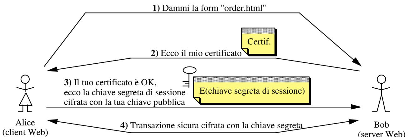
**Figura 8-18:** Funzionamento del protocollo SSL
