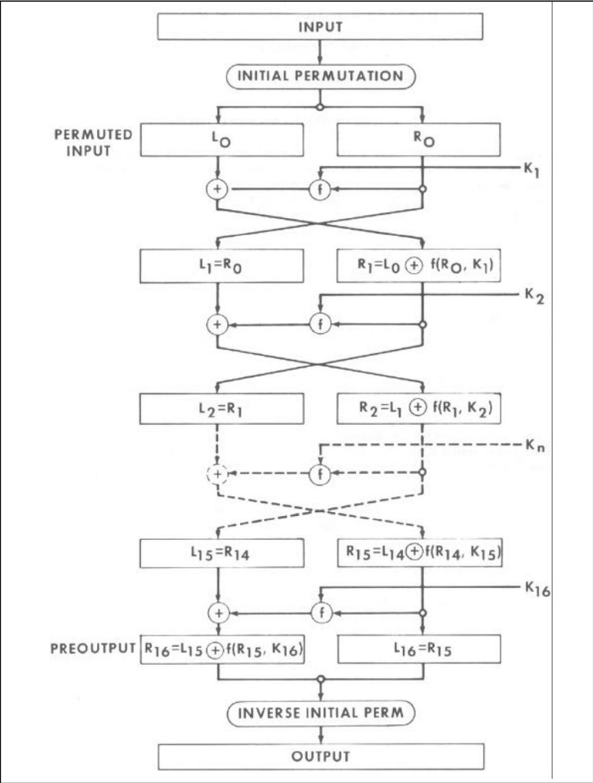
Figura 8-6: Schema complessivo del DES
