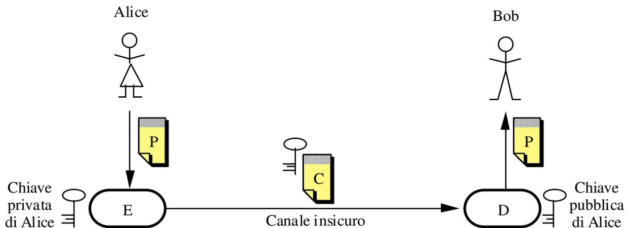
**Figura 8-11:** Autenticazione mediante crittografia a chiave pubblica
