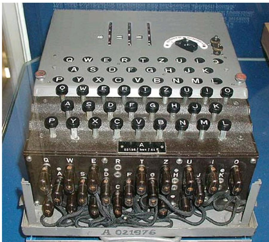
**Figura 8-3:** Un esemplare di Enigma a tre rotori
