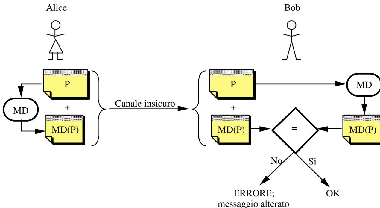
**Figura 8-13:** Uso del digest per il controllo di integrità del messaggio
