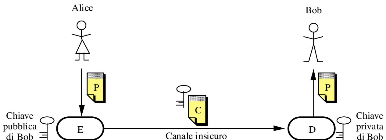
Figura 8-10: Riservatezza mediante crittografia a chiave pubblica
