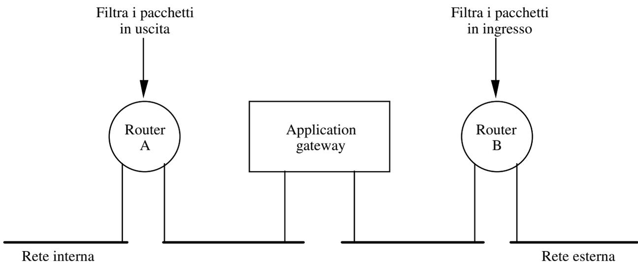
**Figura 8-24:** Tipica configurazione di un firewall
