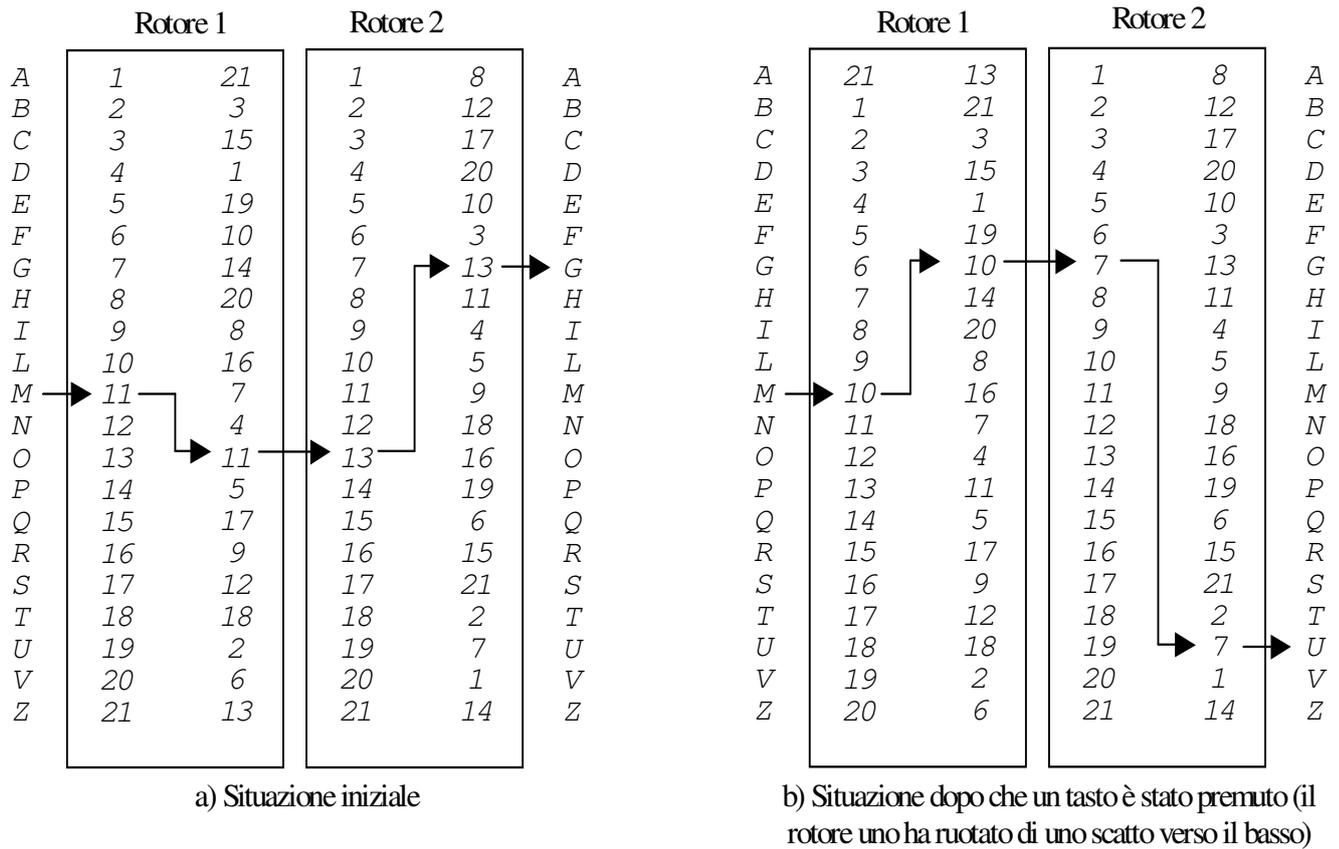
**Figura 8-4:** Macchina a due rotori
